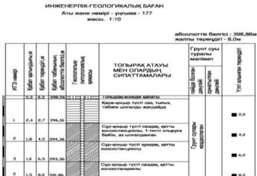
3.4-сурет - № 177 ұңғымасы бойынша инженерлік-геологиялық бағаны
