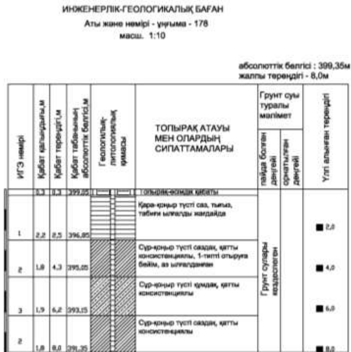
3.5- сурет - № 178 ұңғымасы бойынша инженерлік-геологиялық бағаны
